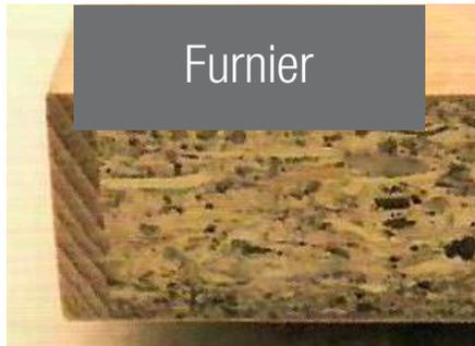
Furnier ist dünn geschnittenes „Massivholz“ mit einer Dicke von bis zu 8 mm. Durch Aufleimen auf Holzwerkstoffe erreicht man eine ähnliche Optik wie bei Massivholz und reduziert gleichzeitig die Empfindlichkeit durch Schwankungen der Luftfeuchtigkeit.
