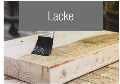
Es werden umweltverträgliche Lacksysteme verwendet. Diese schützen die Möbeloberfläche. Sie werden als Klarlack oder Farblack von matt bis hochglänzend oder als Strukturlack verarbeitet. Metallische Trägerwerkstoffe (Beschlagteile) werden auch pulverbeschichtet, wobei trockenes Lackpulver auf dem Träger „eingebraunt“ wird.
