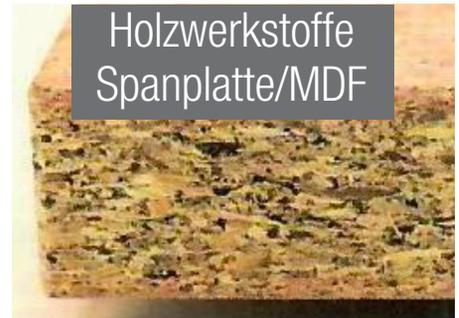
Holzwerkstoffe ist der Sammelbegriff für Plattenmaterial, das aus Holzfasern, Holzspänen oder Furnieren besteht. Die Spanplatte wird aus beleimten Holzspänen unter hohem Druck und Temperaturen von etwa 100°C hergestellt. Die Mittellage besteht aus groben Spänen, die Decklage aus feinen Spänen. Dadurch entsteht ein „Beplankungseffekt“ der die Formstabilität der Platte gewährleistet. Spanplatten werden immer mit Furnieren oder Kunststoffen beidseitig beschichtet.
